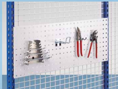
Lochrückwand als Zubehör zur Aufnahme von Hakensystemen für Werkzeug. Mit Systemlochung 10 x 10 mm. Lochraster 38 mm, Höhe 380 mm. Erhältlich in den Systembreiten 625, 1000 und 1250 mm. Auch vor Gitterelement einhängbar.
