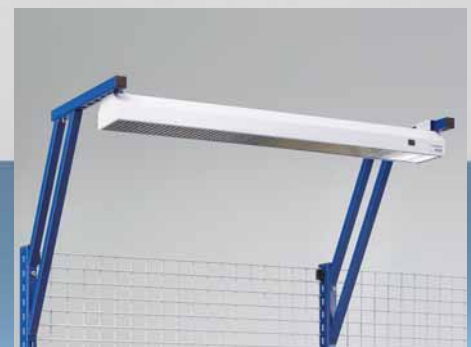
Arbeitsplatzleuchte mit elektronischem Vorschaltgerät (EVG). Wieland Ein- und Ausgang zum Verketteten mehrerer Arbeitsplätze. Optimale blendfreie Ausleuchtung durch ein speziell verspiegeltes Parabolraster.
